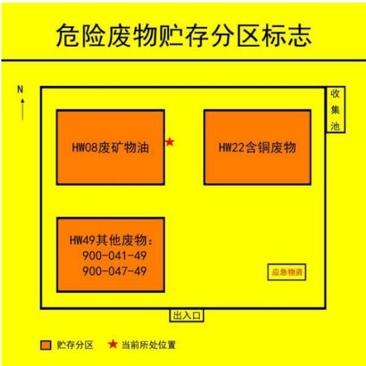
（危险废物贮存分区标志）
