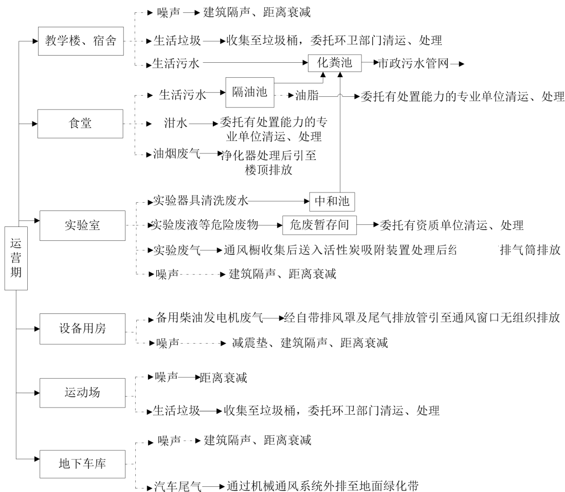
图 2-3 项目运营期工艺流程及产污节点示意图
