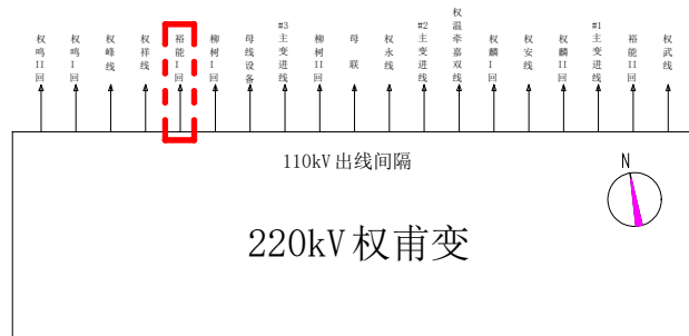
图 2-1 220kV 权甫变间隔使用和规划情况
