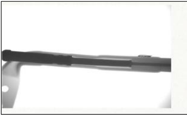
图 9-2 工件 X 探伤下的透视图
