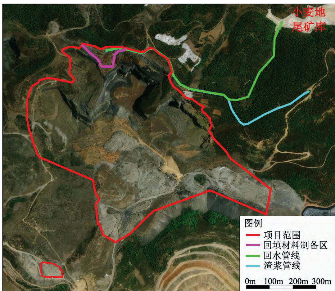
图 2.2-30 项目渣浆管线及回水管线图
