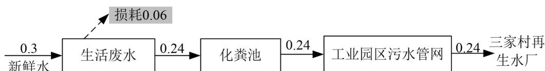
图 2-1 项目水量平衡图单位：m<sup>3</sup>/d
